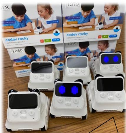
「Codey」と「Rocky」の二つのパーツを組合せて使います。LEDディスプレイや距離・色・光・音センサー等、豊富な機能が搭載されており、自由度の高いプログラミングが可能です。従来のプログラミング学習に加えて、画像認識・音声認識やインターネットからの天候情報取得といった次世代のAIやIoT機器を模した機能を持つ、プログラミング学習教材です。※事前にアプリのインストールが必要です。
