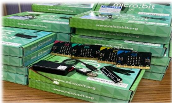
micro:bit は、付属の USB ケーブルでパソコンと接続して使用できます。基盤にはディスプレイとして使用する 25 個の LED のほか、加速度センサー・磁力センサー・無線通信機能などが搭載されています。パソコンと接続せずに、電池を接続して使用することもできます。セット内容 (micro:bit、USB ケーブル、電池ボックス、スピーカー)
