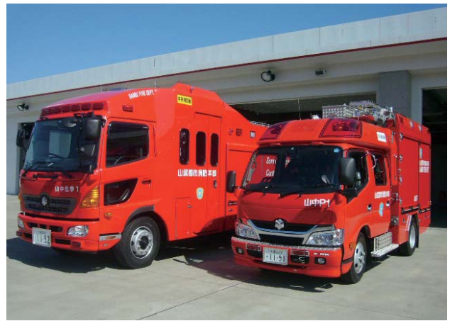
(左から)バス型キャブの化学消防自動車、CAFS搭載の消防ポンプ自動車
