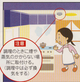
◎台所(煙が多く発生するため熱感知器)
